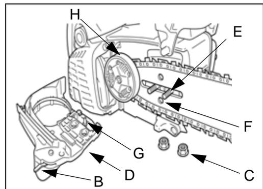
6. Instale protector de la rueda dentada sobre los espárragos de la barra guía. Asegúrese de que el pasador (G) del tensor de la cadena encaje en el agujero (F) y que la banda del freno esté colocada alrededor del tambor del embrague (K). Apriete las tuercas de el protector de la rueda dentada con los dedos.
