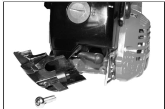
Nota: Algunas unidades pueden tener un calzo de metal (A) entre la cubierta del silenciador y la cubierta del embrague. Asegúrese de que el calzo esté bien instalado al rearmar las piezas.
