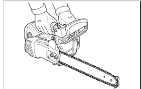
Haga arrancar el motor, fijese que esté funcionando correctamente. Apriete el gatillo para abrir completamente la aceleración y empiece el corte. Si la cadena está afilada correctamente, el corte exigirá relativamente poco esfuerzo. No es necesario empujar hacia abajo con mucha fuerza para hacer que la sierra corte. Si la sierra se empuja con mucha fuerza se disminuirá la velocidad del motor y, en realidad, se dificultará el corte.
