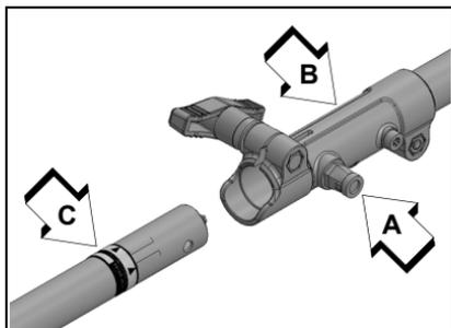
**Nota:** La carcasa del cojinete inferior y el conjunto de la cabeza deben estar alineados con el motor.
