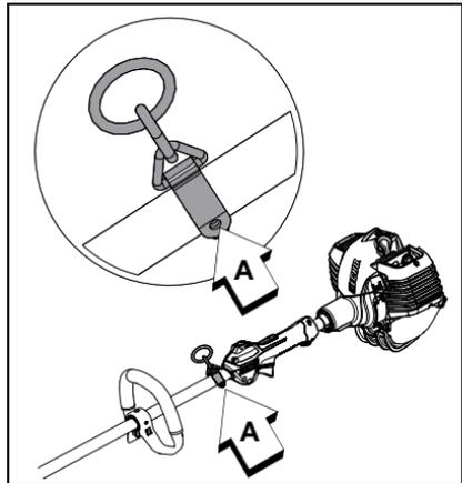
3. Deslice el gancho del arnés (A) hacia arriba o hacia abajo hasta que la unidad se equilibre con el accesorio de corte o hoja  $200\text{ mm} \pm 100\text{ mm}$  ( $8\text{ in} \pm 4\text{ in}$ ) del terreno (B).
