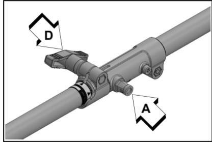
6. Asegure el conjunto del eje inferior al acoplador apretando la perilla de sujeción (D).
