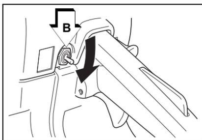
**Nota:** Si el motor no se detiene, tire de la perilla de control del ahogador totalmente para detener el motor.
