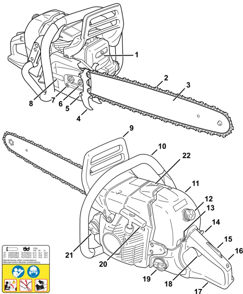
1. Silenciador apagachispas o silenciador apagachispas con catalizador
