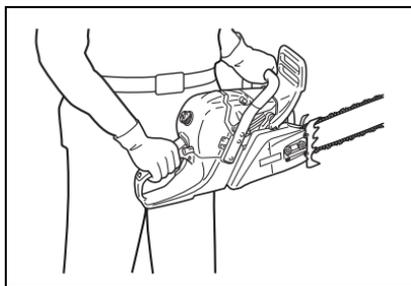
Haga arrancar el motor, fíjese que esté funcionando correctamente. Apriete el gatillo para abrir completamente la aceleración y empiece el corte. Si la cadena está afilada correctamente, el corte exigirá relativamente poco esfuerzo. No es necesario empujar hacia abajo con mucha fuerza para hacer que la sierra corte. Si la sierra se empuja con mucha fuerza se disminuirá la velocidad del motor y, en realidad, se dificultará el corte.
