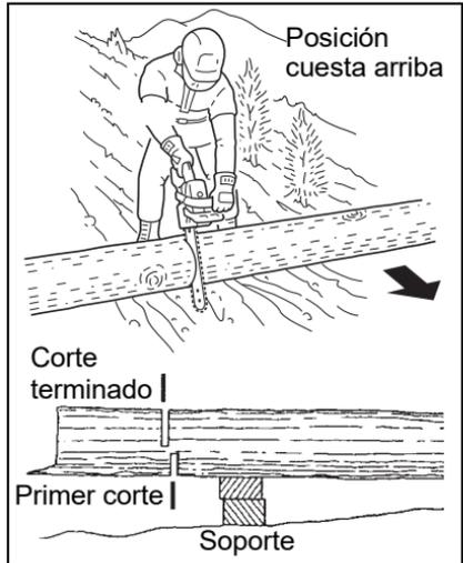
Recuerde que la madera es pesada y que doblará y comprimirá la sierra si está apoyada incorrectamente. El tronco se debilitará en el punto en que se haga el corte, a menos que el árbol se encuentre sobre un terreno perfectamente plano o esté apoyado como se muestra. Si hace el corte con el árbol sobre el suelo, no deje que la cadena de la sierra se hunda en la tierra, es dañino para la sierra y es muy posible que lo golpeen los desperdicios volantes.
