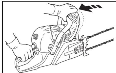
3. Sujete la barra de guía con la nariz apuntando hacia arriba y gire la tornillo del tensor (A) hacia la derecha hasta que la cadena haga contacto con la parte inferior de la barra de guía.
