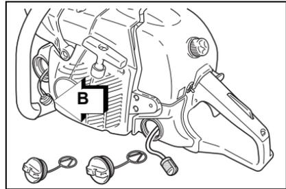
1. Saque el colador por el orificio de aceite usando un alambre doblado en forma de gancho e inspecciónelo.
