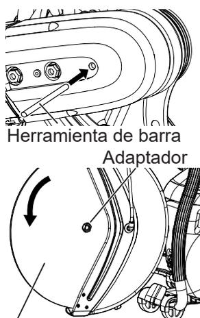
4. Confirme la dirección de rotación de la rueda de corte y móntela de modo que su orificio central quepa sobre el adaptador montado en el eje de transmisión.
