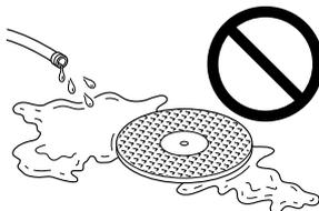
La humedad y el calor pueden causar daños en las ruedas. No deje que las ruedas se acuesten al sol ni las exponga a altas temperaturas. Mantenga las ruedas secas en todo momento y guárdelas en un área de baja humedad y temperatura moderada. La protección contra el daño por humedad se aplica durante el corte por descarga de agua.
