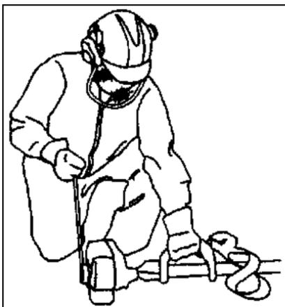
Nota: Si el motor no arranca con el estrangulador en la posición de "marcha" después de 5 tirones, repita las instrucciones 2 - 5.
